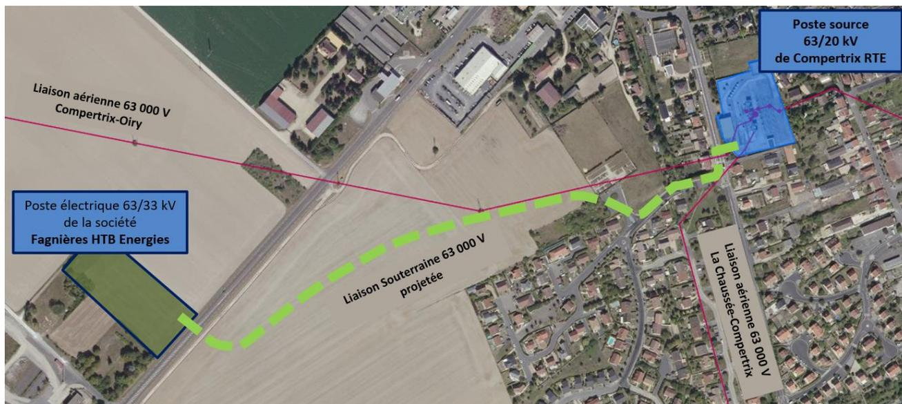
Figure 6a : Tracé de la liaison souterraine 63 kV Compertrix-Fagnières initialement proposé
