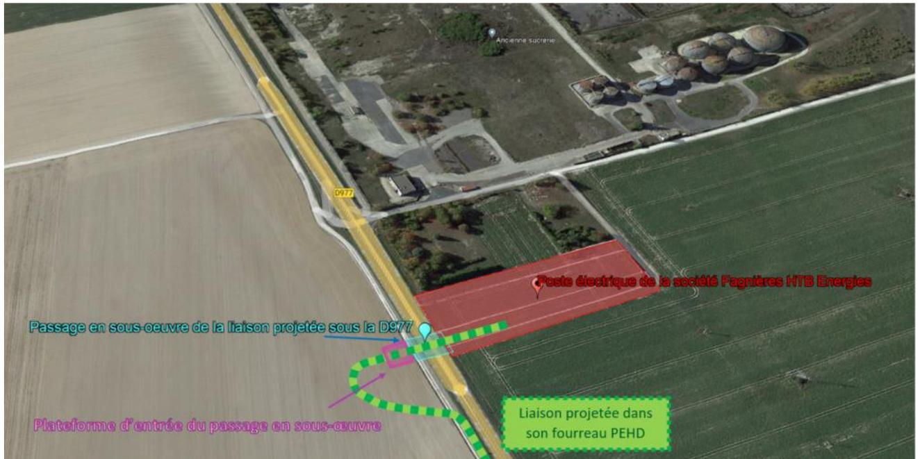
Figure 11a : Traversée de la D977 en sous-œuvre
