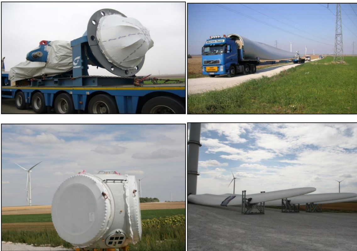
Figure 14 : Photos illustrant l'acheminement et le stockage des éléments des éoliennes – Source : NORDEX
