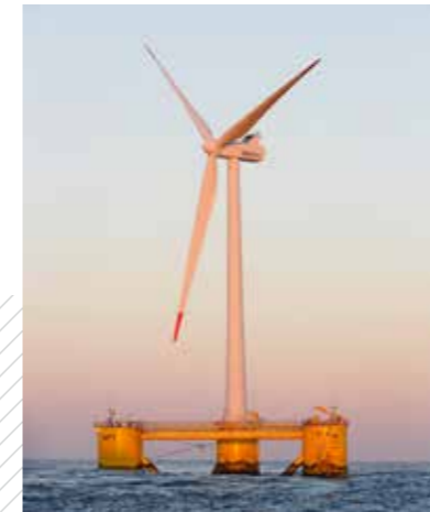
Figure 3 : Prototype d'éolienne flottante mise en service au Portugal par EDPR (source : EDPR)
