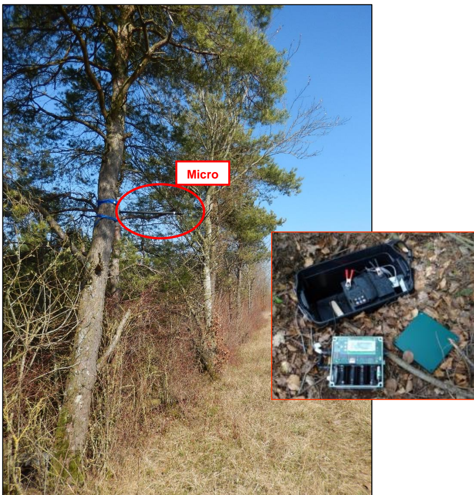
Figure 57 : Illustrations du dispositif de détection automatique (SM2Bat+)
