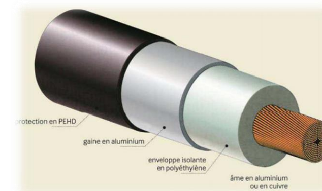
Figure 33 : Exemple de câble de raccordement électrique souterrain (Source : RTE)
