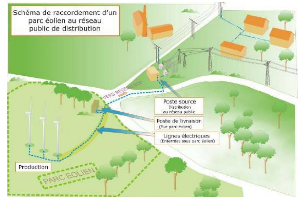
Figure 4 : Composants du parc éolien
