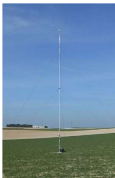
Figure 5: Photographie du mât météorologique.
