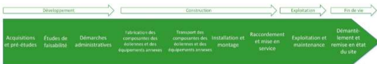
Figure 8g : Chaîne de valeur type d'un parc éolien (Source : Green Energy 3000 GmbH)
