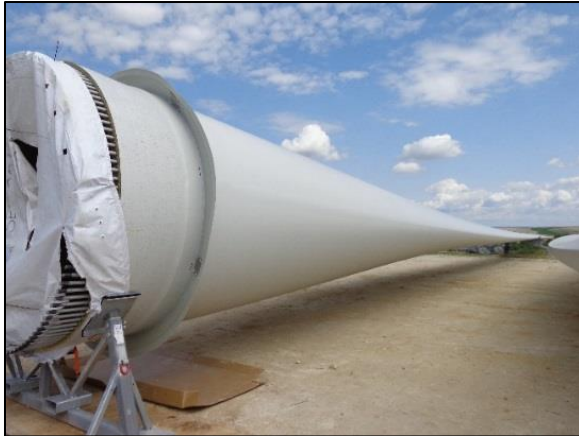
Photo 1 : Une pale V112 (Source : document interne à l'entreprise)
