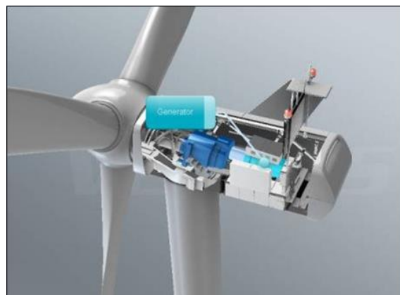
Figure 20 : Localisation du générateur dans la nacelle (Source : EISE, Vestas)
