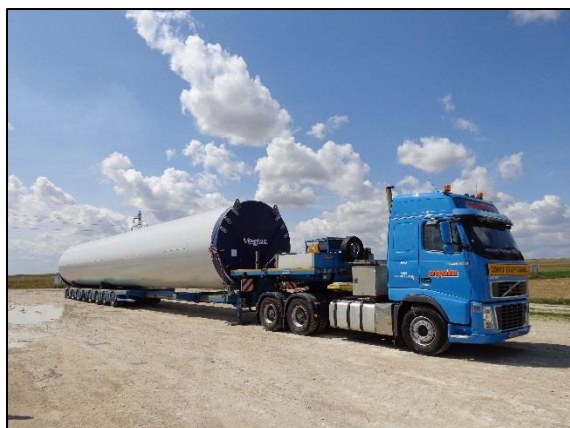
Photo 11 : Transport d'une section du mât (Source : documents internes à l'entreprise)
