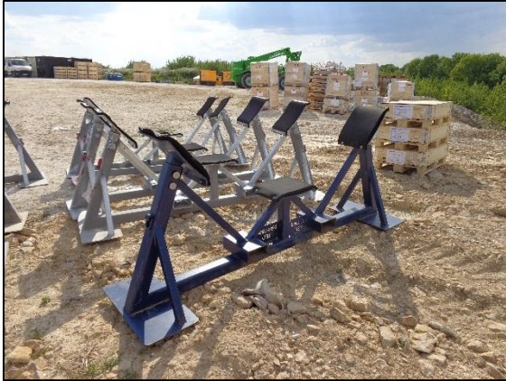
Photo 12 : Cales pour poser les pales (Source : document interne à l'entreprise)
