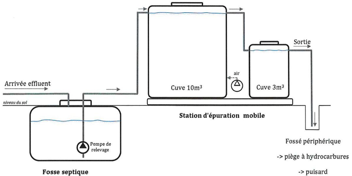
Principe de fonctionnement de l'installation de traitement des effluents sanitaires
