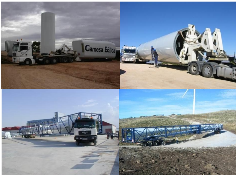
Photo 7. Transport des composantes des éoliennes
