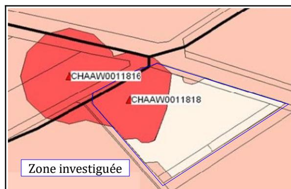
La présence d'affaissement traduit un comblement de mauvaise qualité. Le niveau d'aléa autour des cavités est donc classé comme fort. En l'absence d'investigation plus large et au vu de l'altitude et du niveau de la nappe, le niveau de susceptibilité de présence autour de la zone investiguée est considéré comme fort. Ce niveau est confirmé par la présence de cavités et d'indices sur ce même secteur. Le reste de la zone investiguée par microgravimétrie a été déclassée en zone d'aléa faible à nul.
