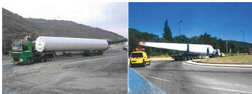
Figure 30 : Transport de mât et transport de pale - Source : Eléments de Servion
