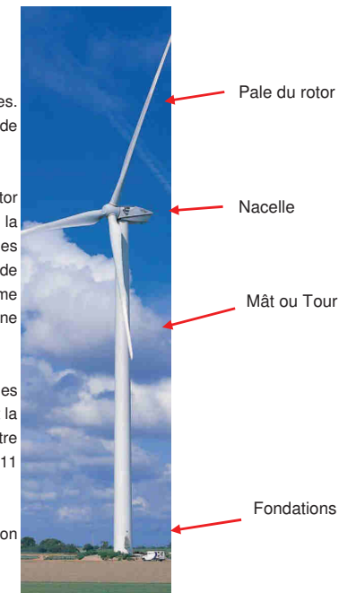
Figure 4 : Description d'une éolienne Source : Tauw France
