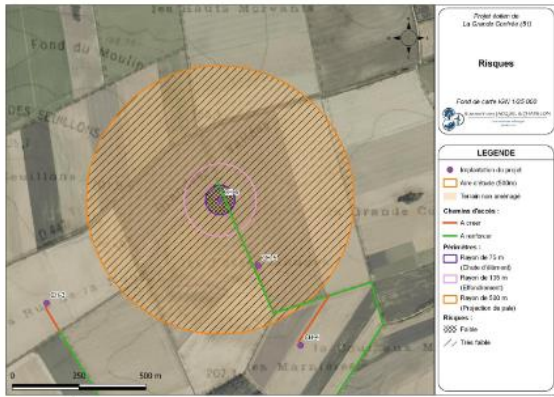
Carte 34 : Éolienne CH-6 - Risques liés à l'effondrement de l'éolienne, à la chute d'élément de l'éolienne, et à la projection de palet ou de fragment de palet (Source : BE Jaquetel et Chantillon)
