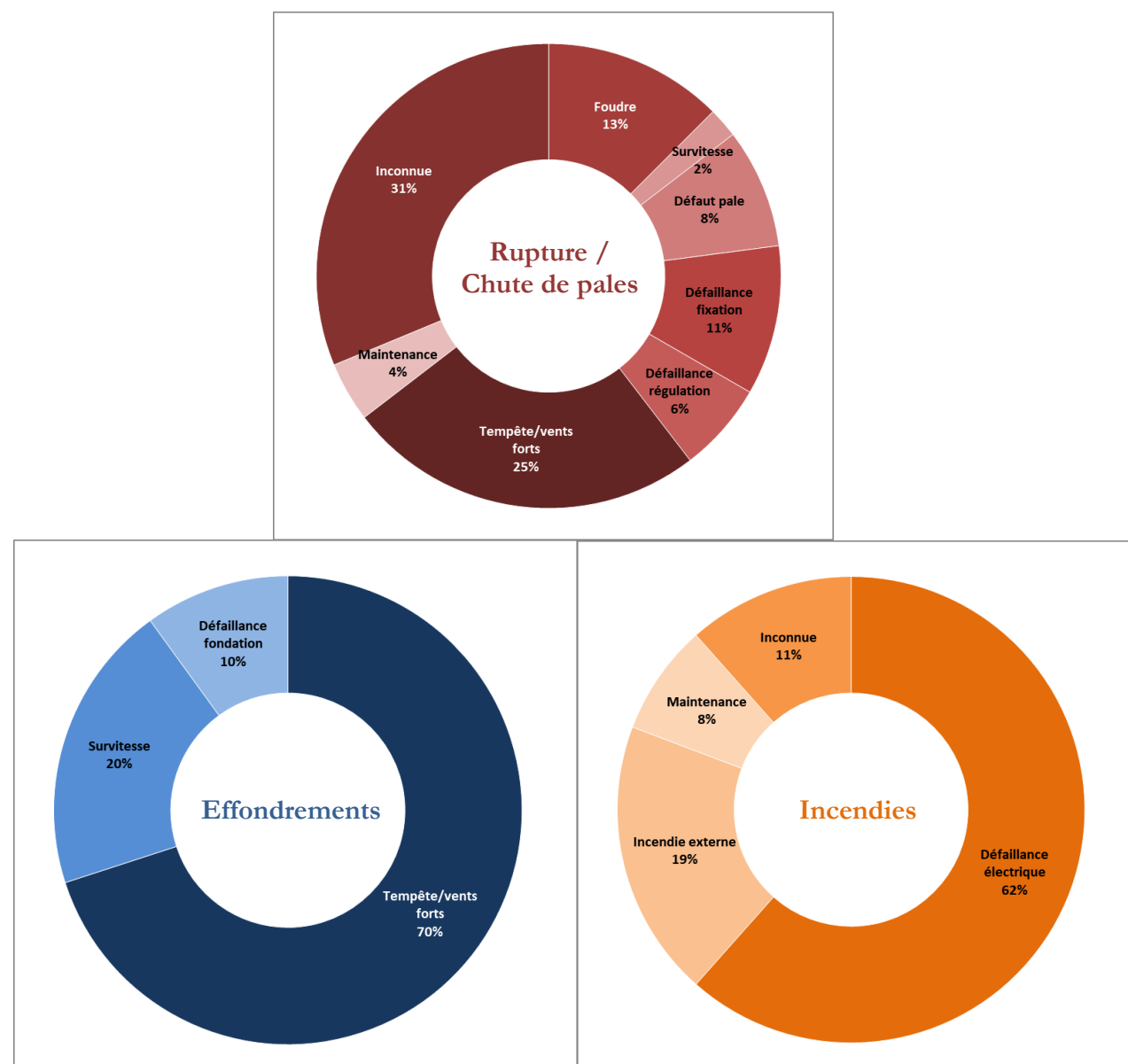
Figure 5 : Répartition par cause des principaux événements accidentels sur le parc éolien français entre 2000 et 2021 (Source : BE Jacquel et Chatillon)
