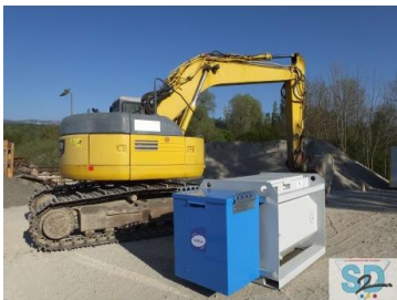
Ci-contre, exemple de cuve de chantier en acier double paroi agréé ADR (Accord pour le transport des marchandises Dangereuses par la Route) pour le transport plein sur la voie publique, homologué emballage groupe III pour le transport et le stockage de gasoil, GNR, huile... Chantier – Exemple type – Source : © pro-equipements.com
