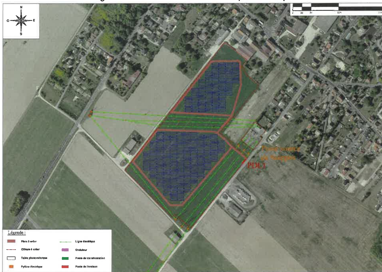
Figure 10 : Plan de masse de la centrale photovoltaïque
