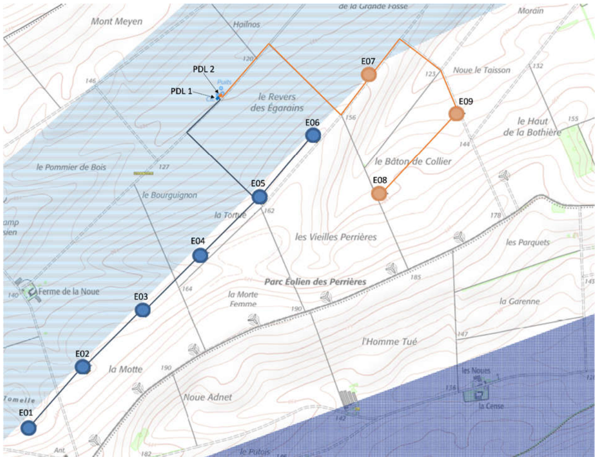
Figure 8 : Schéma de raccordement du projet PEP II
