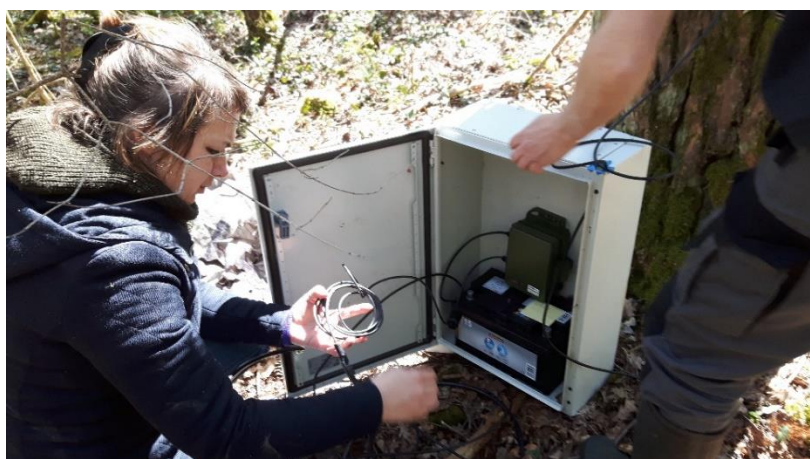
Paramétrage du matériel de suivi chiroptérologique longue durée en canopée ( Ecosphère, 2018 )
