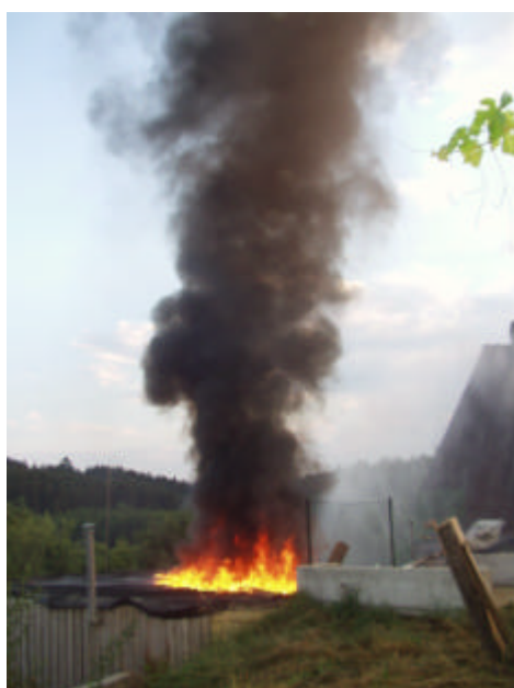
Image 17: La membrane se consume sur l'isolant
