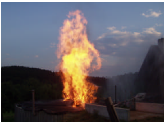
Image 14: Le biogaz se consume avec une flamme claire.
