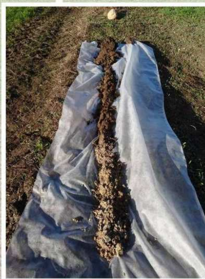
4. Carotte obtenue au fur et à mesure du sondage
