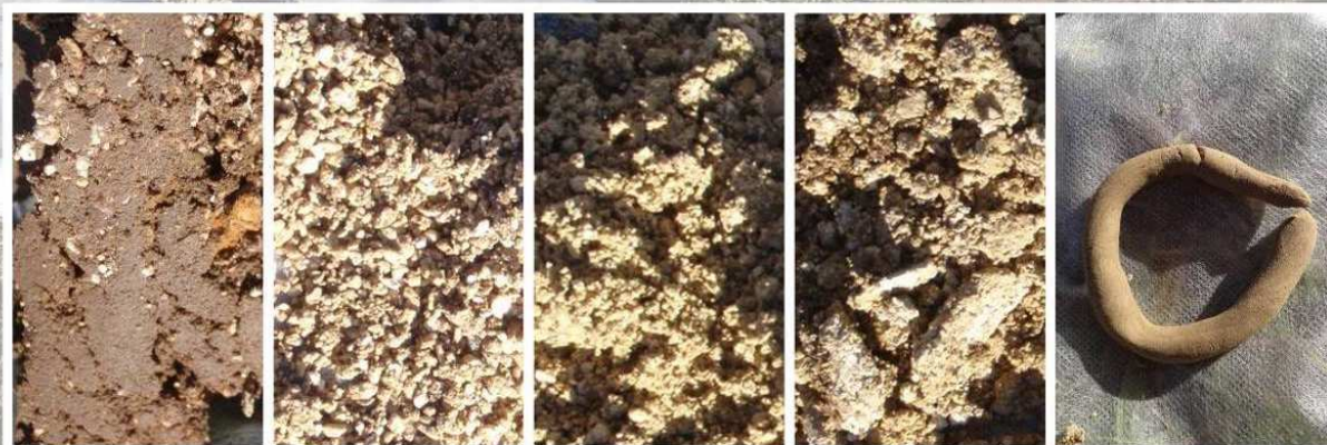
5. Examen du sol sur l'ensemble de la carotte prélevée : couleur, texture, structure. à droite, test de plasticité : pouvant former un boudin refermable en un cercle, le substrat présente 20 à 30% d'argile
