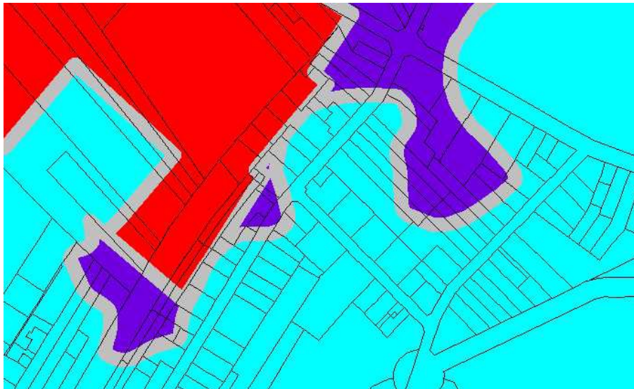
Exemple de zonage réglementaire sur fond cadastral, faisant apparaître les 10 mètres d'incertitude (bande grisée)
