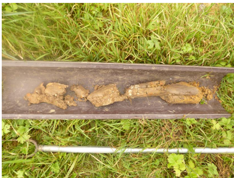
Figure 5 : profil de sol du sondage 1.
