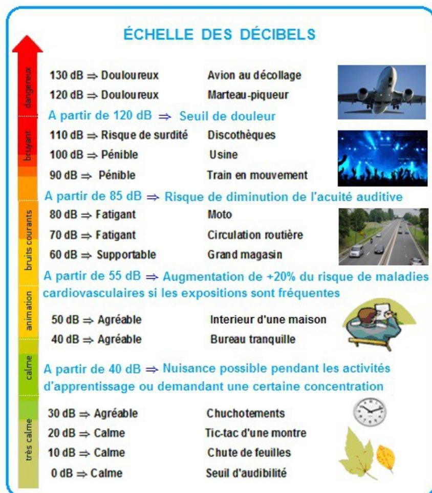
Le niveau d'un bruit (fort ou faible) correspond aux variations de pression de l'air ambiant, exprimées en Pascal (Pa). Comparées à la pression atmosphérique (105 Pa), les variations de pression audibles sont très faibles, de 20  $\mu$ Pa à 100 Pa environ.
