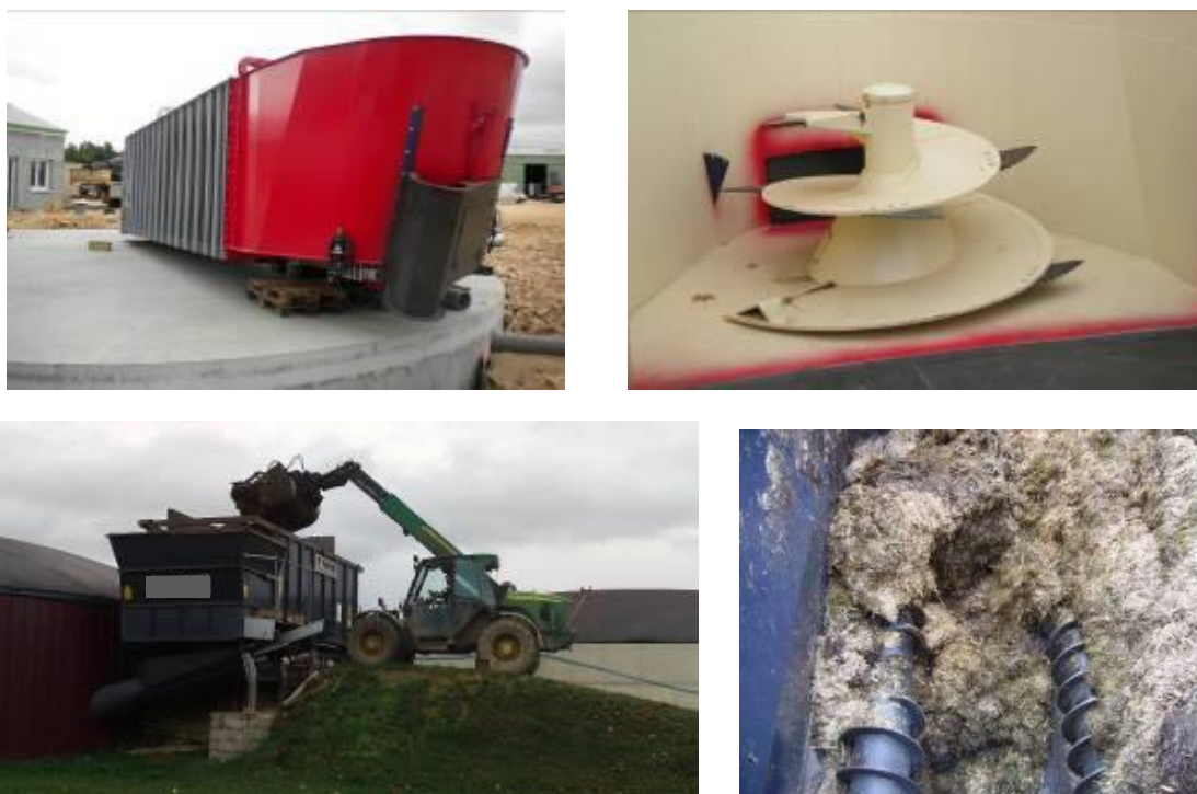
Figure 1 : Exemples de systèmes d'incorporation à fond poussant des matières solides par le dessus (haut) et par le côté (bas)
