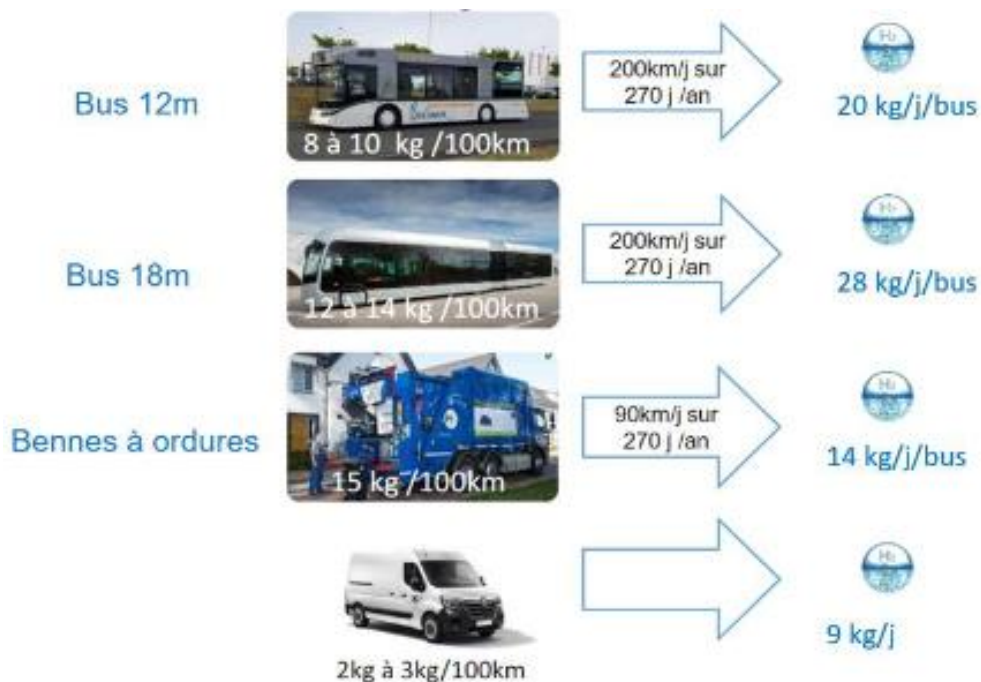
Figure 19 : Illustration des quantités de H2 consommées en fonction du type de véhicules. Source TotalEnergies Renouvelables France
