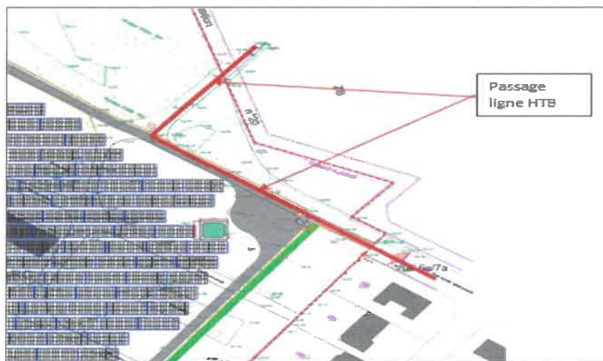
^ Localisation ligne HTB ENEDIS souterraine sous la piste du projet.
