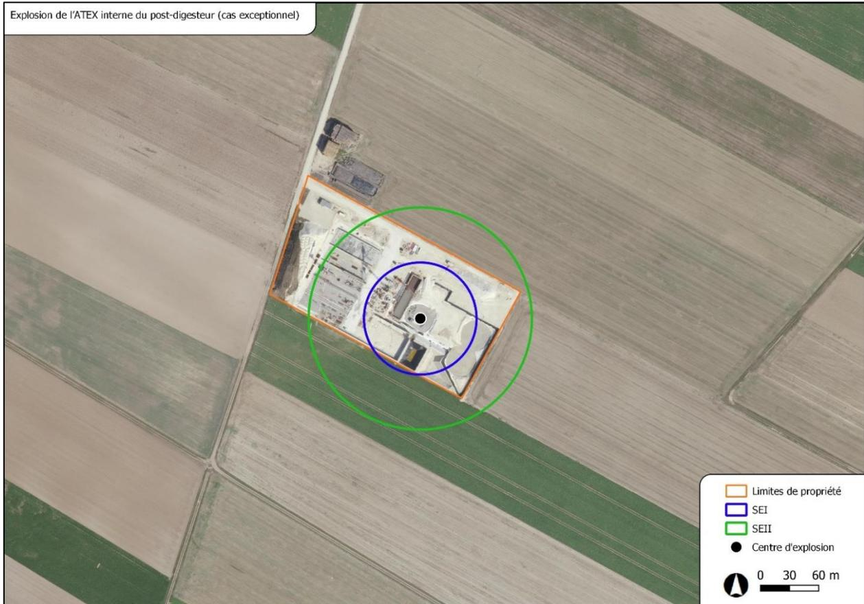
Figure 12 : Cartographie des effets de surpression de l'explosion de l'ATEX interne du post-digesteur (cas exceptionnel)
